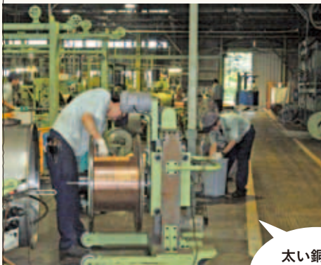
太い銅線を引張って細く延ばします
