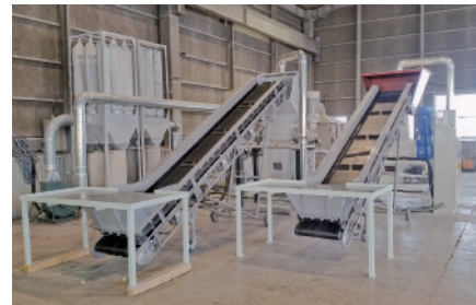
自社での細断処理は1時間に約3000kgの処理が可能な2基の大型裁断機で。完全予約制です。
