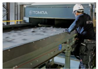
破碎された自動車片が高速のベルトコンベアで運ばれる様子。奥でメタルセンサーにより選別。
