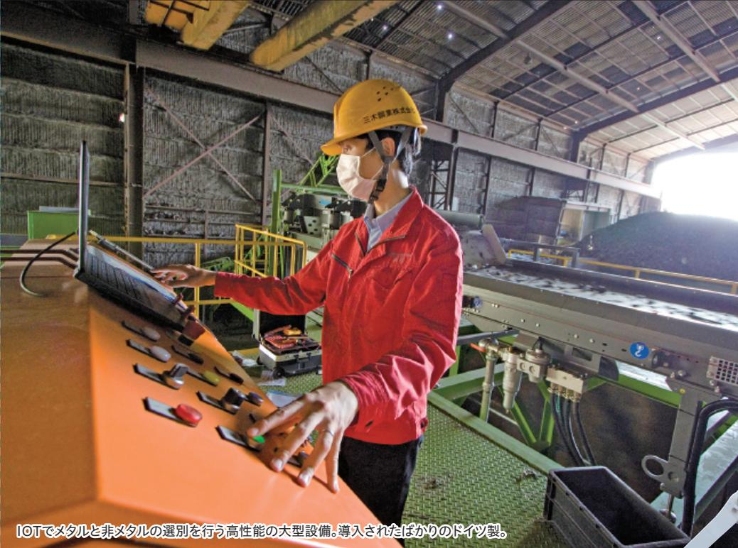
IoTで金属と非金属の選別を行う高性能の大型設備。導入されたばかりのドイツ製。
