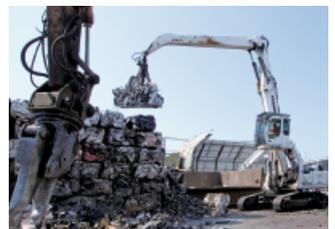
部品を抜いた後の自動車を方形に圧縮して坂出工場に集積。破碎・分別して資源にします。
