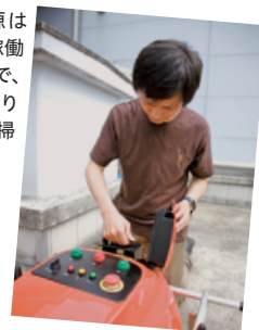
工場や建物の屋上設置型ソーラーパネル向けの清掃ロボットType1。パネルの配置を認識してブラシで砂や汚れを払い落とします。
