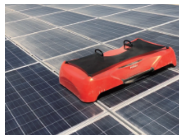
工場や建物の屋上設置型ソーラーパネル向けの清掃ロボットType1。パネルの配置を認識してブラシで砂や汚れを払い落とします。
