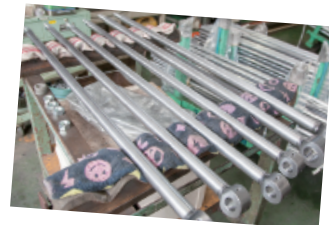
硬質クロムめっき加工が施される前の部材。加工部位は棒部分のみ。
