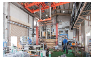
硬質クロムめっき槽に部材を入れ、電流を流してめっきを付着させます。
