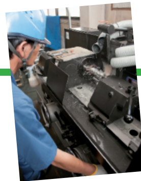
振れを矯正する円筒研削盤。精密に研削する技術が求められます。
