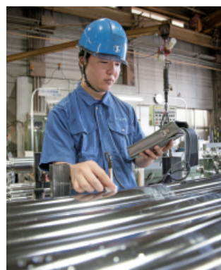
品質検査では、食品ラップほどの厚みのめっき皮膜を計測します。
